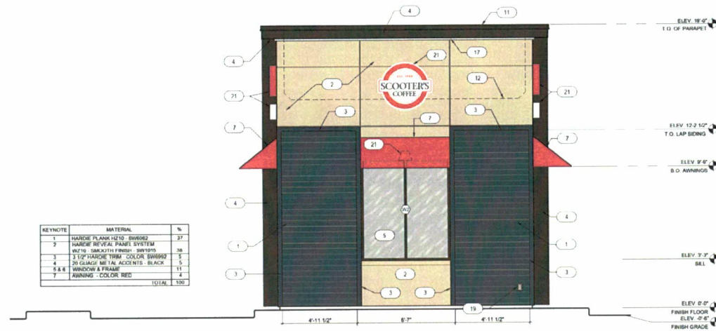
2 EXTERIOR ELEVATIONS SCALE: 3/8" = 1'-0"
